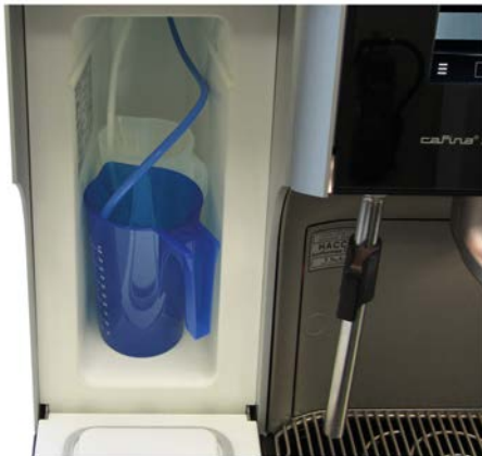
Rys. 52: Niebieski pojemnik do czyszczenia z węzem mleka
