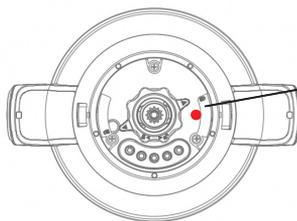
Кнопка регулировки температуры
