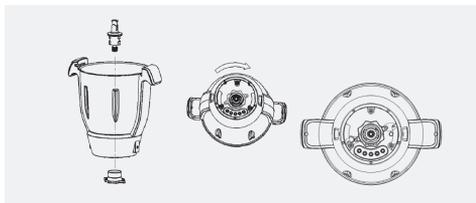
Umieść pojemnik na podstawie. Wciśnij pojemnik, aż do zablokowania (logo powinno znajdować się po frontowej stronie podstawy, a znacznik poziomu maksymalnego – z tyłu).
