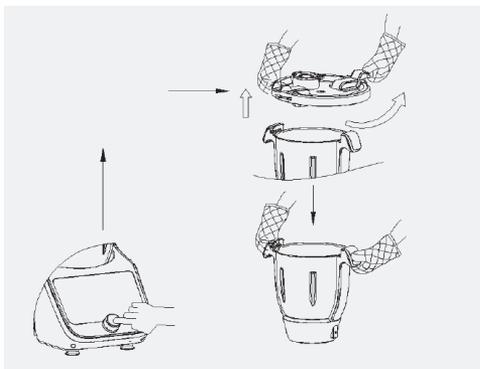
După gătire, ecranul indică încheierea. Apăsați butonul rotativ iar gătitul se va opri. Dacă doriți să suspendați procesul, apăsați butonul rotativ. Apoi apăsați din nou, iar aparatul va relua gătitul. Aparatul se va opri din gătit dacă apăsați lung pe butonul rotativ.
