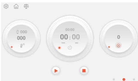
С помощью соответствующих значков-иконок функций или ручки, установите температуру, время и скорость работы устройства. На таймере нажмите минуты или секунды, чтобы установить точное время. Изменение направления вращения: Нажмите значок-иконку
