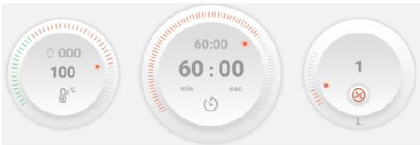
Klicken Sie nach dem Einstellen von Temperatur, Zeit und Geschwindigkeit, um zu starten, Das Symbol ändert sich dann zu , **die Maschine arbeitet jetzt**. Klicken , oder drücken Sie die Taste im Knopf, um die Arbeit zu unterbrechen. Klicken Sie oder drücken Sie kontinuierlich die Taste im Knopf, um die Arbeit zu beenden und das Programm zu beenden.
