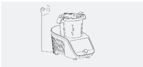
Συνδέστε το καλώδιο τροφοδοσίας στην κύρια βάση και ενεργοποιήστε την συσκευή. Όταν η κύρια βάση έχει το ενσωματωμένο το καλώδιο τροφοδοσίας, μην αφαιρείτε το καλώδιο τροφοδοσίας.
