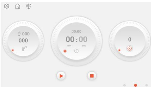
Posunutím příslušné ikony nebo otočením knoflíku nastavíte teplotu, čas a rychlosti. Kliknutím na minuty nebo sekundy v ikoně času rychle nastavíte přesný čas. Reverzní funkce: Kliknutím na ikonu
