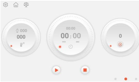
Schieben Sie das entsprechende Symbol oder drehen Sie den Knopf, um Temperatur, Zeit und Geschwindigkeit einzustellen. Klicken Sie im Zeitsymbol auf die Minute oder Sekunde, um schnell die genaue Zeit einzustellen. Reverse - Funktion : Klicken Sie auf das Symbol für Schaltdrehrichtung.
