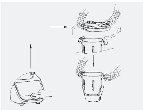
Po dokončení vaření se na obrazovce zobrazí informace o konci. Stiskněte otočný knoflík a vaření se zastaví. Pokud chcete proces pozastavit během vaření, stiskněte otočný knoflík. Poté znovu stiskněte toto tlačítko a na sporáku bude pokračovat proces vaření. Vaření se na sporáku zastaví, pokud dlouze stisknete otočný knoflík.
