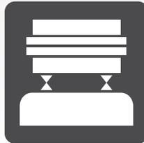
Der Abstand zwischen den heißen Platten und Gehäuse verhindert einen Wärmestau und dadurch verursachte Elektronikschäden.
