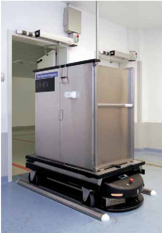
Transporter zostaje w pełni automatycznie przekazany do transportu
