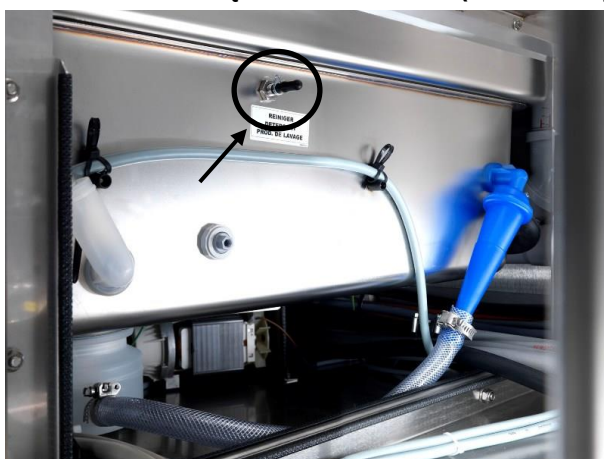
Obraz: Pierwsza strefa głównego zmywania ze złączką dozowania środka czyszczącego
