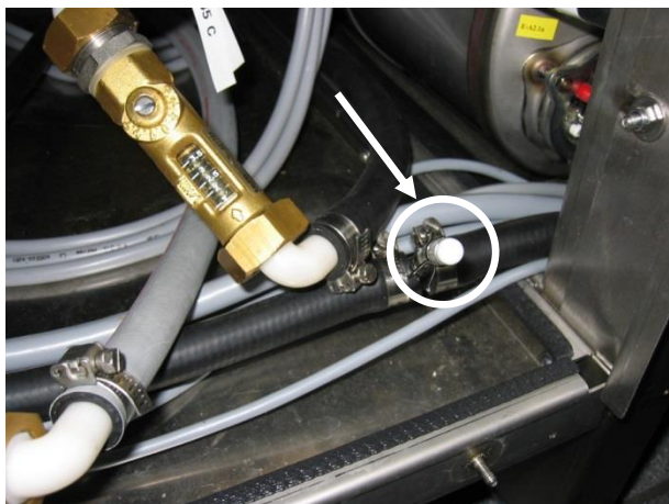
Obraz: ostatnia strefa głównego zmywania ze złączką dozowania nabłyszczacza
